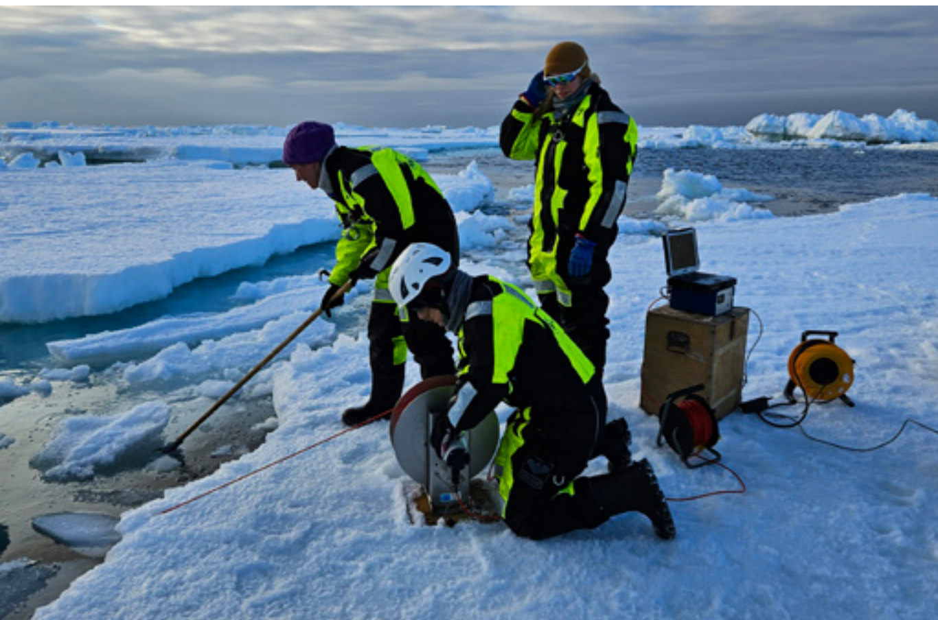
En mikrostruktur-profiler settes ut for å studere turbulens under havisen. Foto: Sebastien Moreau / Norsk Polarinstittutt
