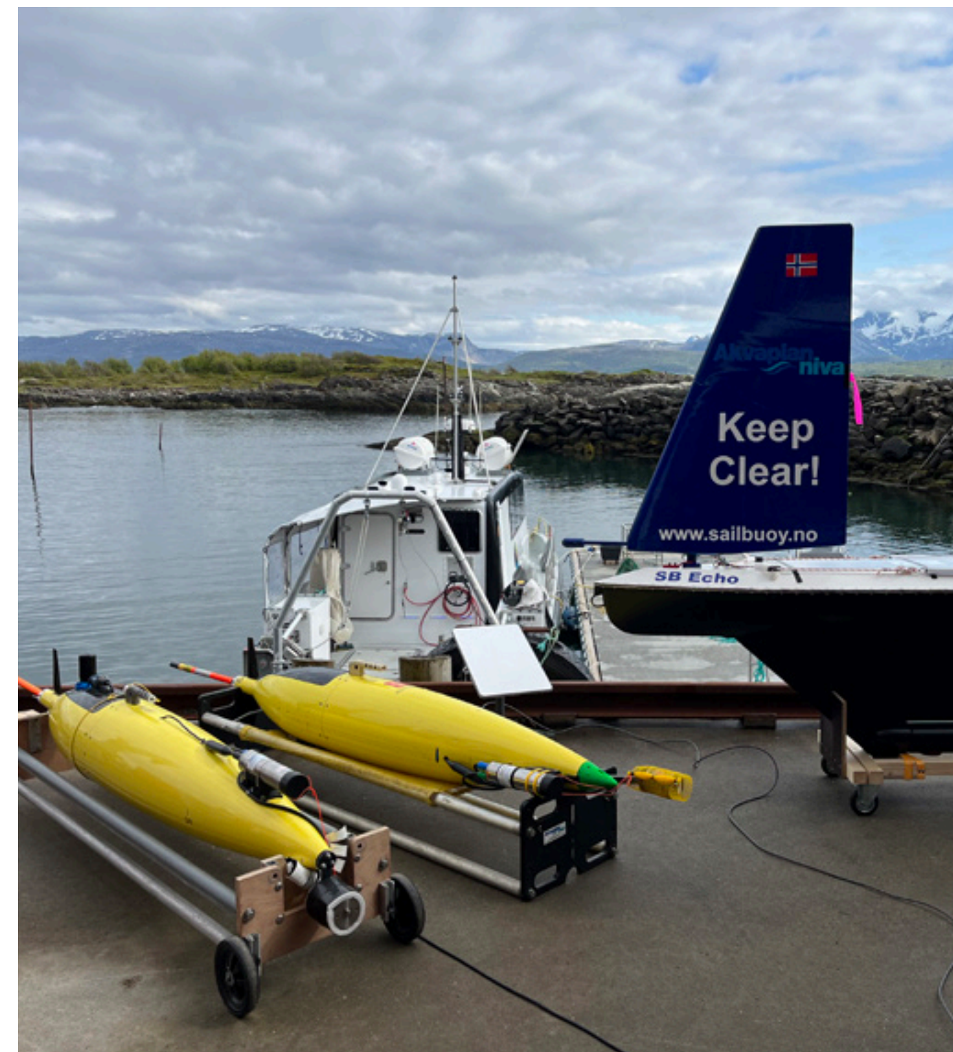
Sailbuoyen utstyrt med et ekkolodd, og to Seaglidere utstyrt med en optisk bildesensor for plankton (UVP6) og et ekkolodd. Foto: Pierre Priou / Akvaplan-niva
