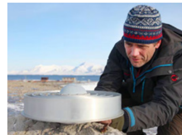
Måling av landheving ved hjelp av GPS. Foto: Bjørn-Owe Holmberg
