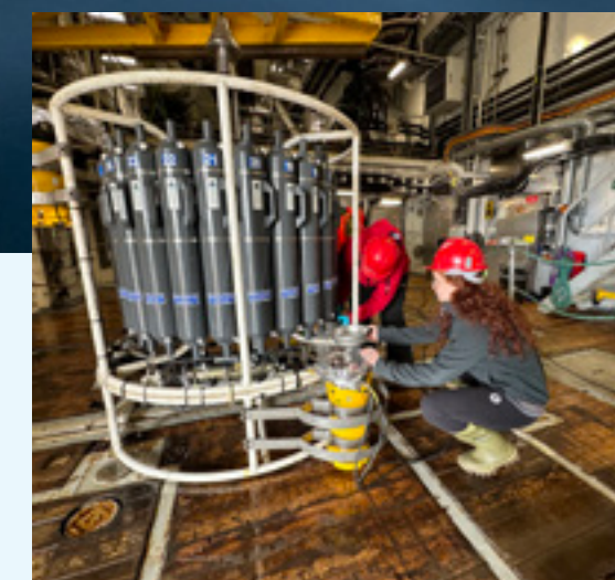
Prøvetaking av overflatevann fra CTD-en i hangaren om bord på FF Kronprins Haakon. Foto: Ann Kristin Balto / Norsk Polarinstitutt
